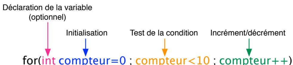
L'initialisation est effectuée en premier et une seule fois. A chaque passage de la boucle, la condition est testée. Si elle est "vrai", le contenu de la boucle `for` est exécuté (par exemple faire clignoter une LED), et l'incrément de la variable est réalisé. Ensuite, la condition est testée à nouveau. Dès que le résultat du test de la condition est "faux", la boucle s'arrête
